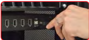
El puerto USB de enlace de subida se conecta a una computadora para sincronizar dispositivos.
