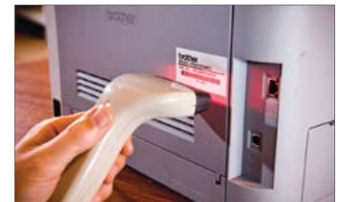
Connectez un scanner de codes à barres au port série de la TD-4000/TD-4100N pour imprimer des étiquettes sans PC.*
